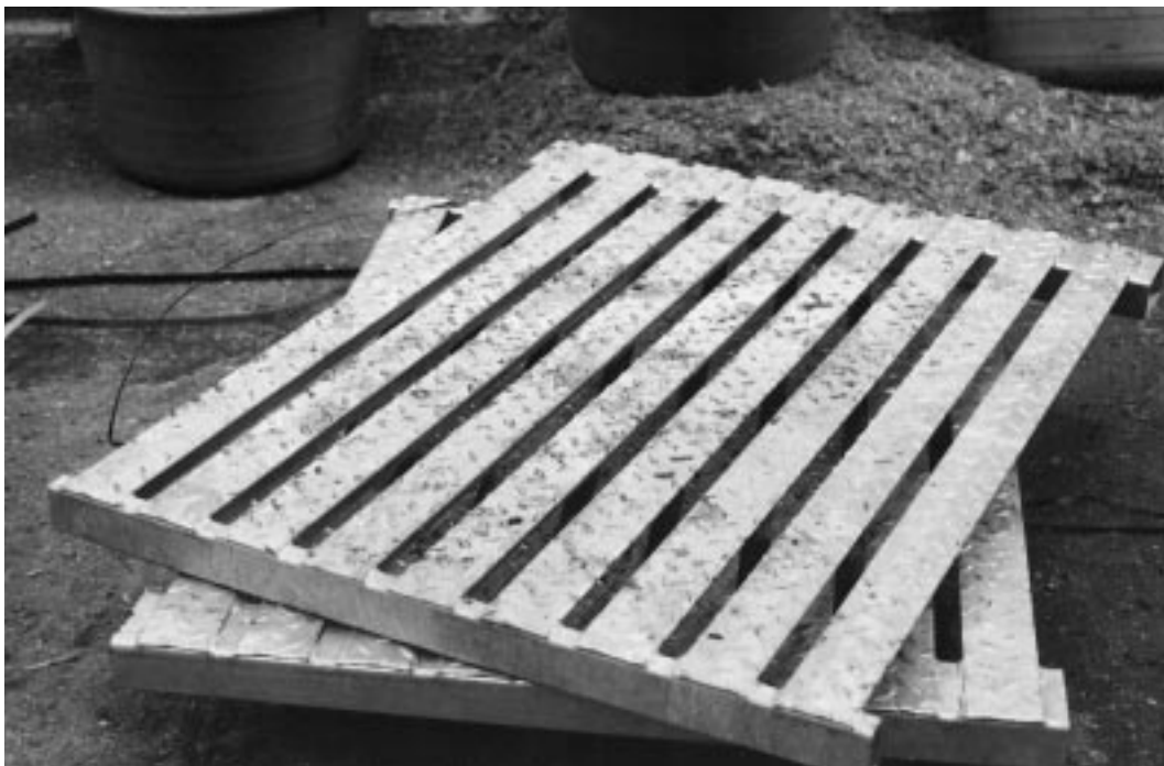
De stalen roosters hebben een grotere mestdoorlaat door een smallere balkbreedte
