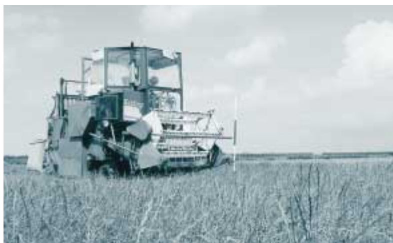
De medewerkers van de proefbedrijven leggen de drogestofopbrengst nauwkeurig vast met behulp van een speciale oogstmachine.
