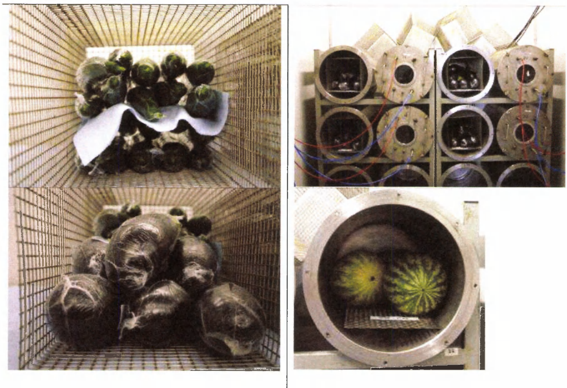
Figuur 1. Het product in de begassingscontainers. Links komkommer en aubergine in één container, rechtsonder watermeloen, met bakje met gebluste kalk als koolzuur scrubber (niet zichtbaar).
