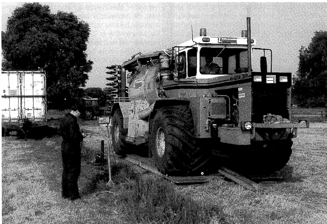
Met een mobiele weegbrug wordt mesttank gewogen. Op de achtergrond de tussenopslag.
