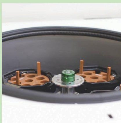
2 In de centrifuge worden de monsters voorbehandeld
