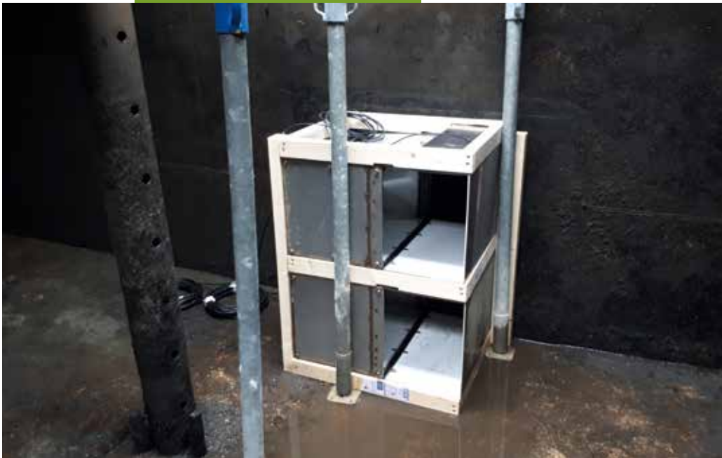
KBTS ontwikkelde een standaardbox voor een onderwatercamera die onder alle omstandigheden dezelfde beelden maakt en ook in troebel water kan worden ingezet.
