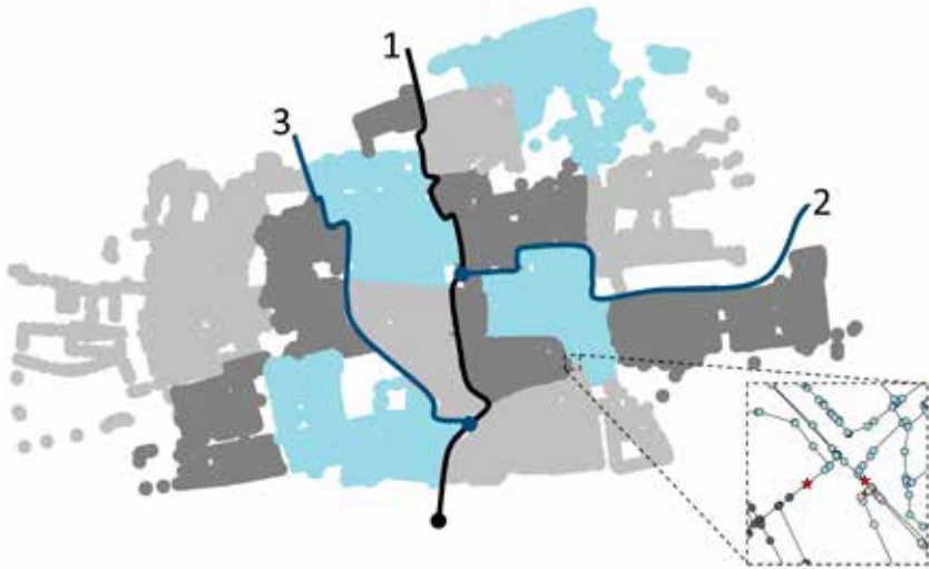
Figuur 2. De gekozen DMA-indeling voor Den Haag. Vlakken met verschillende tinten zijn verschillende DMA's. De drie genummerde lijnen representeren de eerste drie van de acht stappen die de optimale transitie naar deze indeling vormen. In het uitvergroete deel van het netwerk zijn de grenzen tussen DMA's gemarkeerd met een ster
