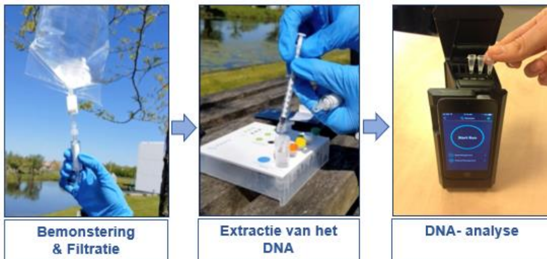
Afbeelding 1. Schematische weergave van de stappen voor het analyseren van watermonsters in het veld met behulp van qPCR. De drie stappen worden doorlopen binnen 1,5 uur
