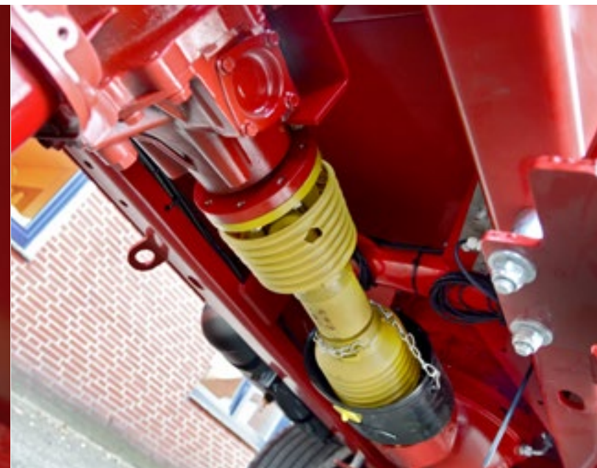
Let op de overbrenging van de versnellingsbak naar de eerste vijzel. Als de tussenas recht loopt, kan deze grotere krachten verdragen.
