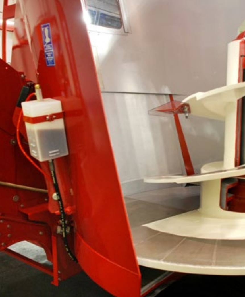
De niet-conische rand op de bodemplaat is kenmerkend voor de Trioliet-voermengwagens. Deze rand is 12 of 15 mm dik.
