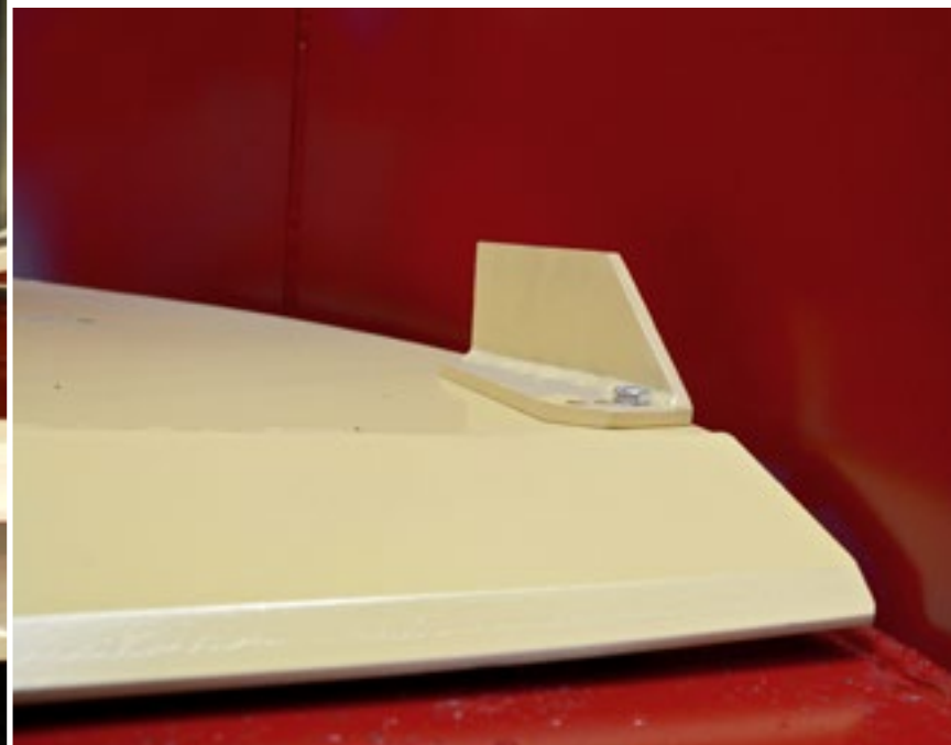
De vijzelschaar is een essentieel hulpstuk gebleken bij het maken van een compact-TMR. De schaar beweegt het mengsel richting vijzelkern.
