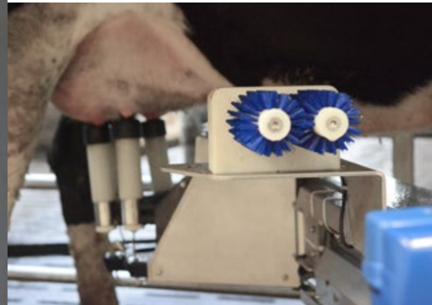
Fullwood heeft een elektrische arm, wat stiller en energiezuiniger is. Het bedrijf kiest er net als Lely voor om de spenen te reinigen met borstels.
