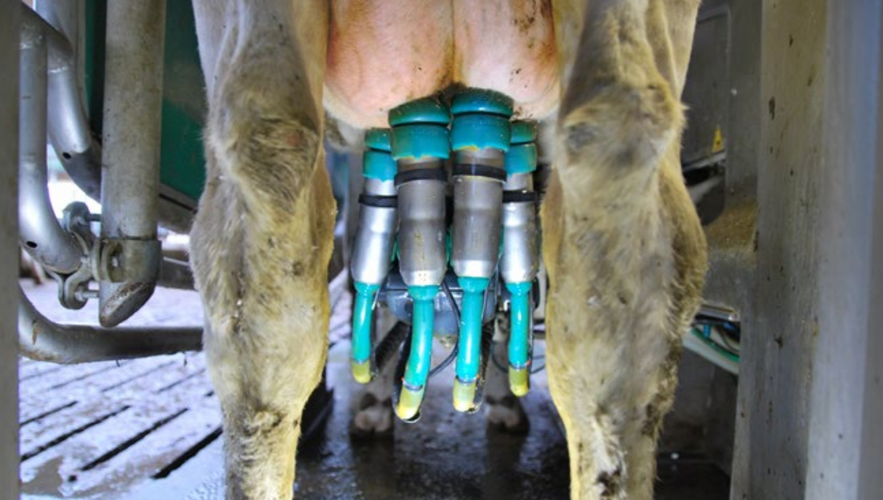
Gea kiest ervoor om alles in de melkbeker te doen. Bij binnenkomst sluit de robot direct de melkbekers aan, en begint met voorbehandelen en het stimuleren van de melkgift. Na het melken gebeurt ook het dippen in de melkbeker.
