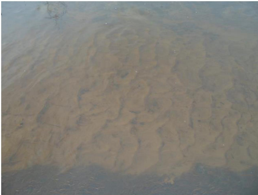
Figuur 4.17. Stroming leidt tot zandribbels op uniform traject 6.
