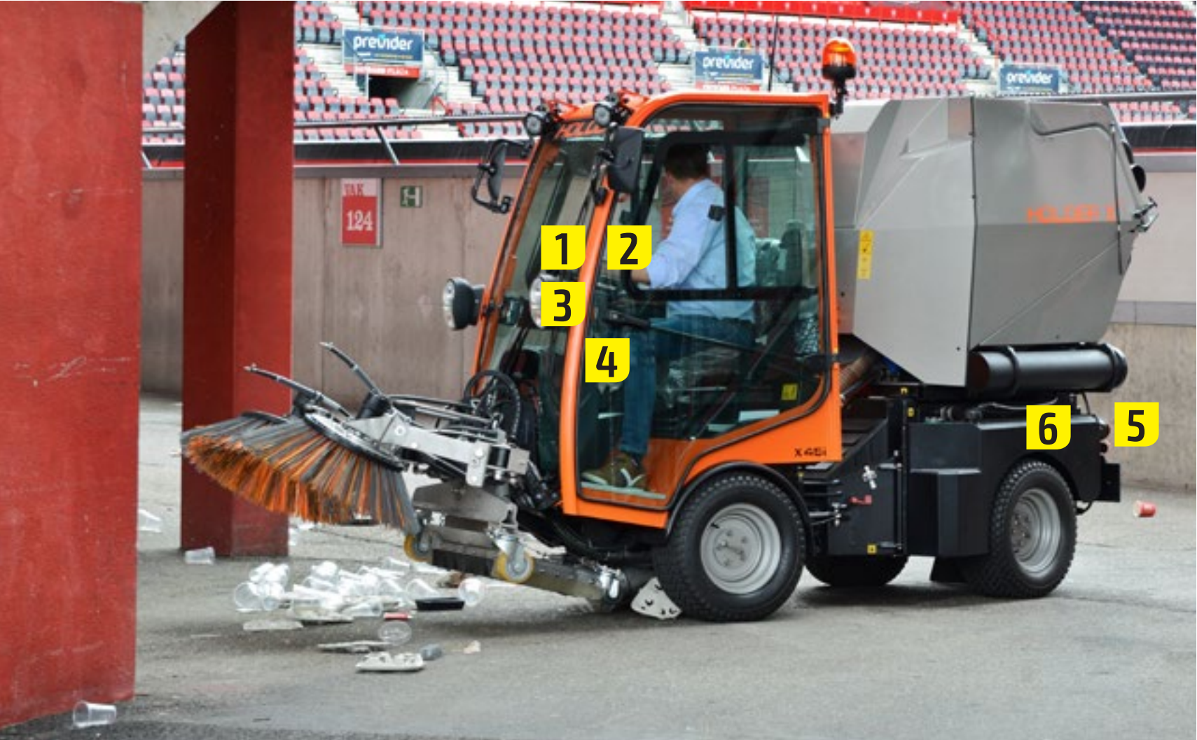
Met de knopjes voor de joystick activeer je de hydrauliek en pas je de oliestroom aan.
