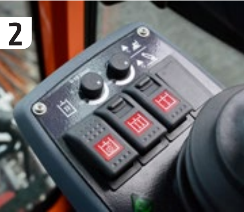
Met de knopjes voor de joystick activeer je de hydrauliek en pas je de oliestroom aan.
