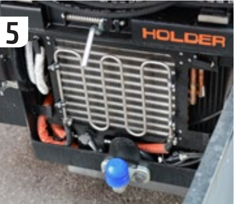
Aan de achterkant van de machine kun je goed bij de radiator komen.
