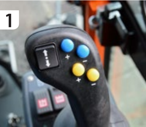
Met de linkschakelaar bepaal je de rijrichting. Met de gekleurde knoppen bedien je twee hydraulische functies.
