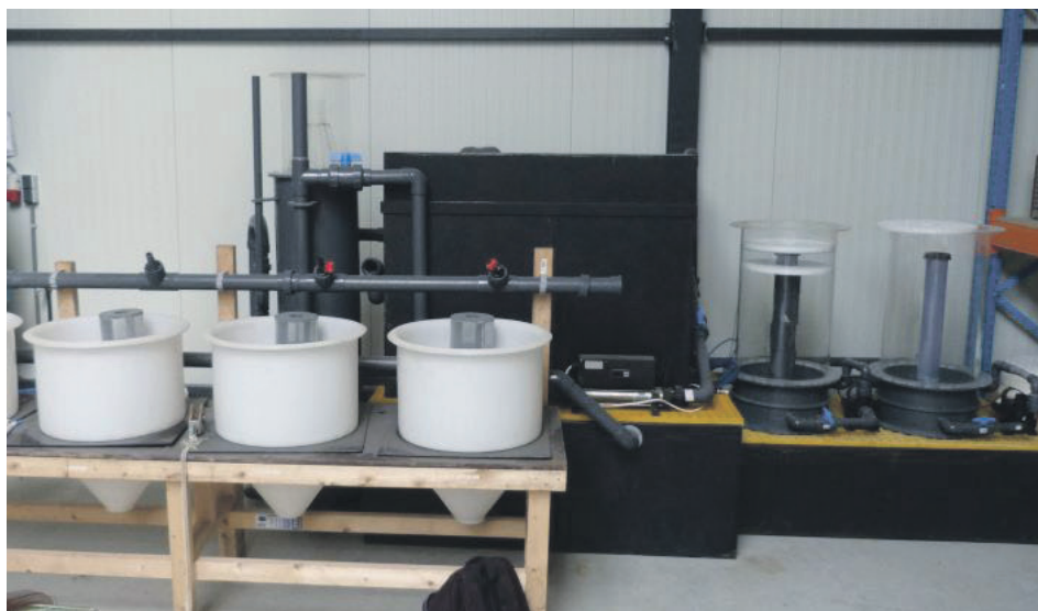
Systeem van Shellfish Hatchery Systems Ltd. met op voorgrond tanks voor kreeften in planktonfase, rechts de doorzichtige tanks voor de aquahives en in de zwarte kast op de achtergrond het waterbehandelingssysteem. (foto: P. van der Heijden)
