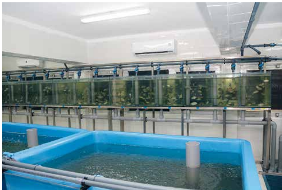
De groeiproef opstelling met vissen, op de voorgrond twee blauwe tanks om de vissen te laten wennen aan het systeemwater.
