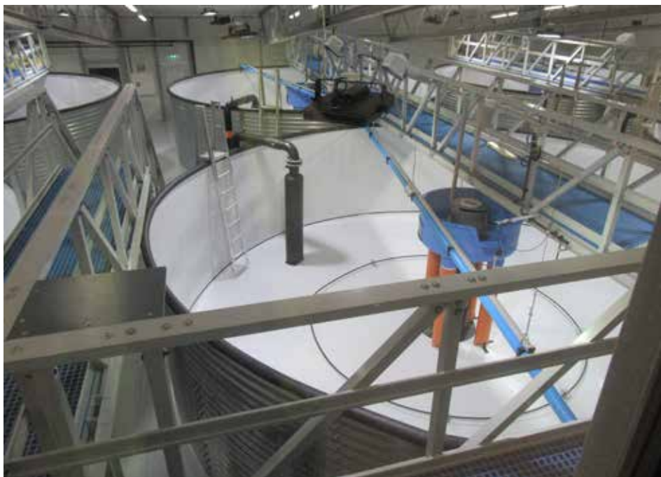
Het kleinste systeem op Fjaera. Het systeem waarin de zalm larven worden gehouden als de dooierzak opgeteerd is.
