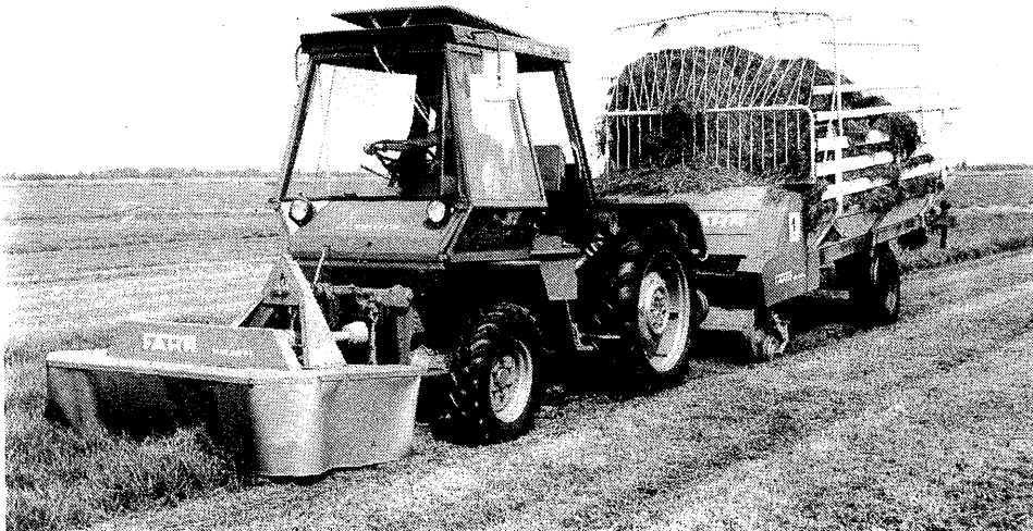
Met deze combinatie kan men het gras in één werkgang maaien en laden. With this combination the herbage can be mown and loaded in one operation.
