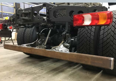
Nieuw en uniek in de sector is de opklapbare stootbalk voor het asfalttransport.
