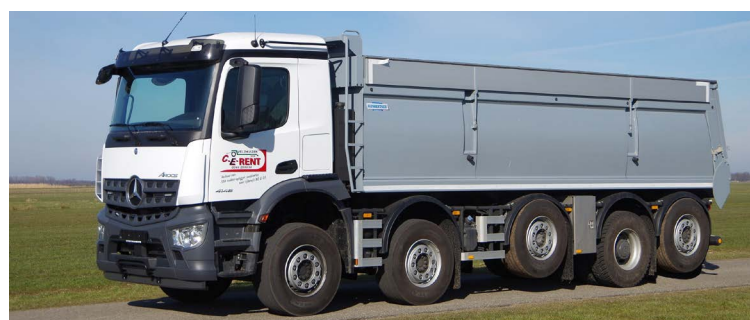
De nieuwe 10 x 2 kenmerkt zich door een lichte bouw, waardoor het laadvermogen is vergroot.
