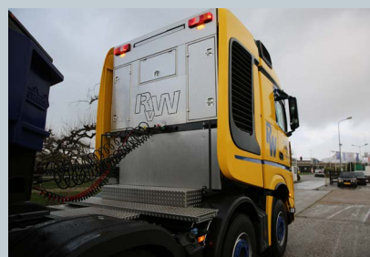
Veldhuizen werkte de SCR-unit, de dieseltank en de luchtketels netjes weg achter de cabine.
