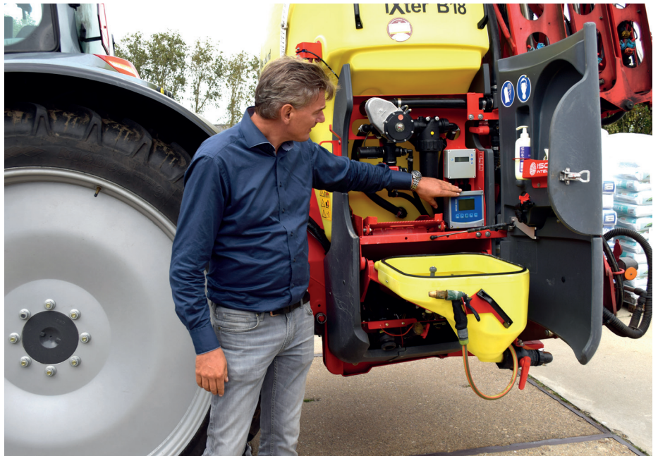
Erik Hogervorst laat de pH-meter zien die op een veldspuit gemonteerd kan worden.
