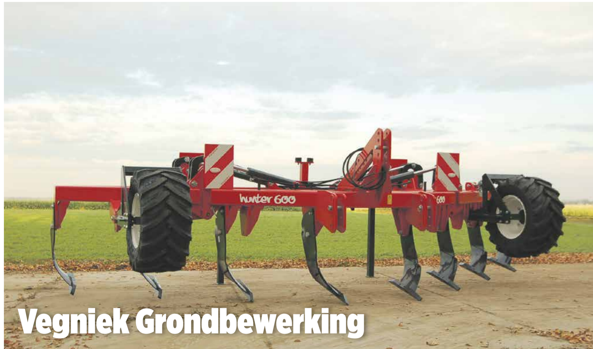
De Hunter 600 is uniek vanwege de zes meter werkbreedte en drie meter transportbreedte.
