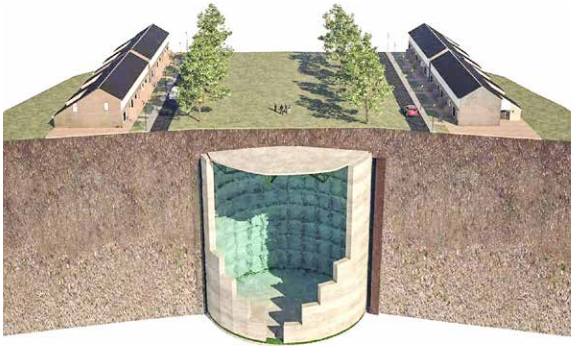
Ecovat is een groot ondergronds buffervat gevuld met water
