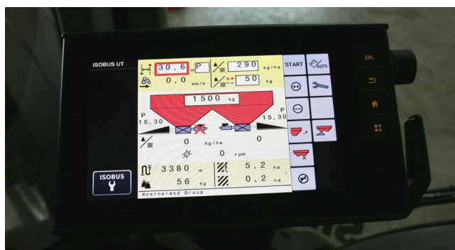
De terminal is volledig Isobus-compatibel. Dat scheelt terminals in de cabine.
