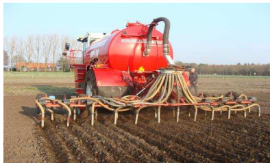
17 april: Bouwlandinjectie voor ploegen
