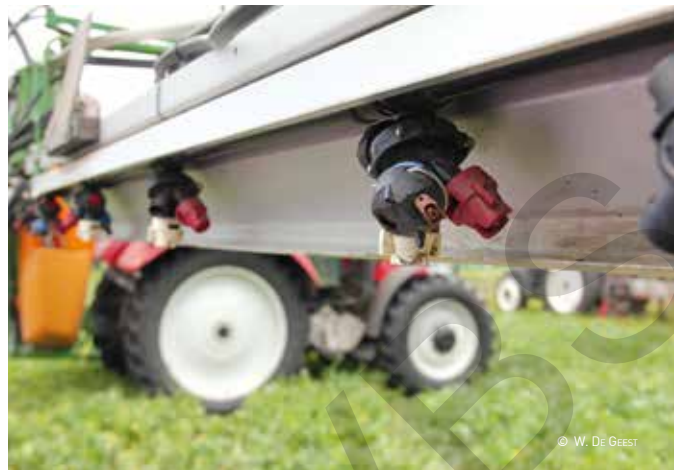
Verplicht gebruik van driftreducerende doppen
