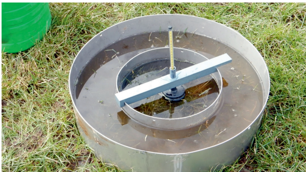
Afbeelding 4: De dubbele-ringinfiltrometers opgesteld in een landbouwperceel
