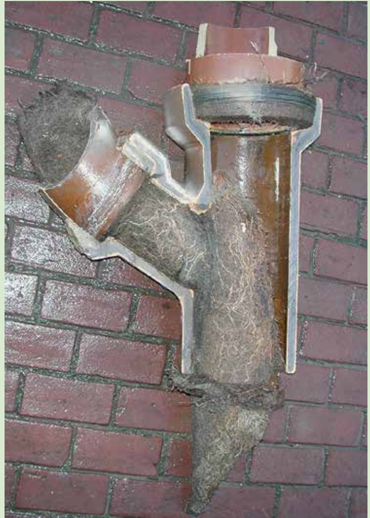
Problemen met wortelingroei zijn vaak te vinden in oudere, keramische rioolbuizen.
