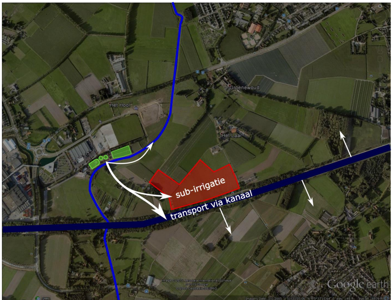
Figuur 1-2: Gezuiverd restwater wordt vanuit de afvalwaterzuivering van Bavaria (groen) in drie richtingen afgevoerd: via een vijzel wordt het water direct aangevoerd naar het landbouwperceel van dhr. Van Dijk (rood) en naar het wilhelminakanaal (donkerblauw). Het kanaal dient hierbij als transportmiddel om ook percelen op grotere afstand van de zuivering van water te voorzien. De (traditionele) lozing op de Goorloop (lichtblauw) wordt zoveel mogelijk beperkt.
