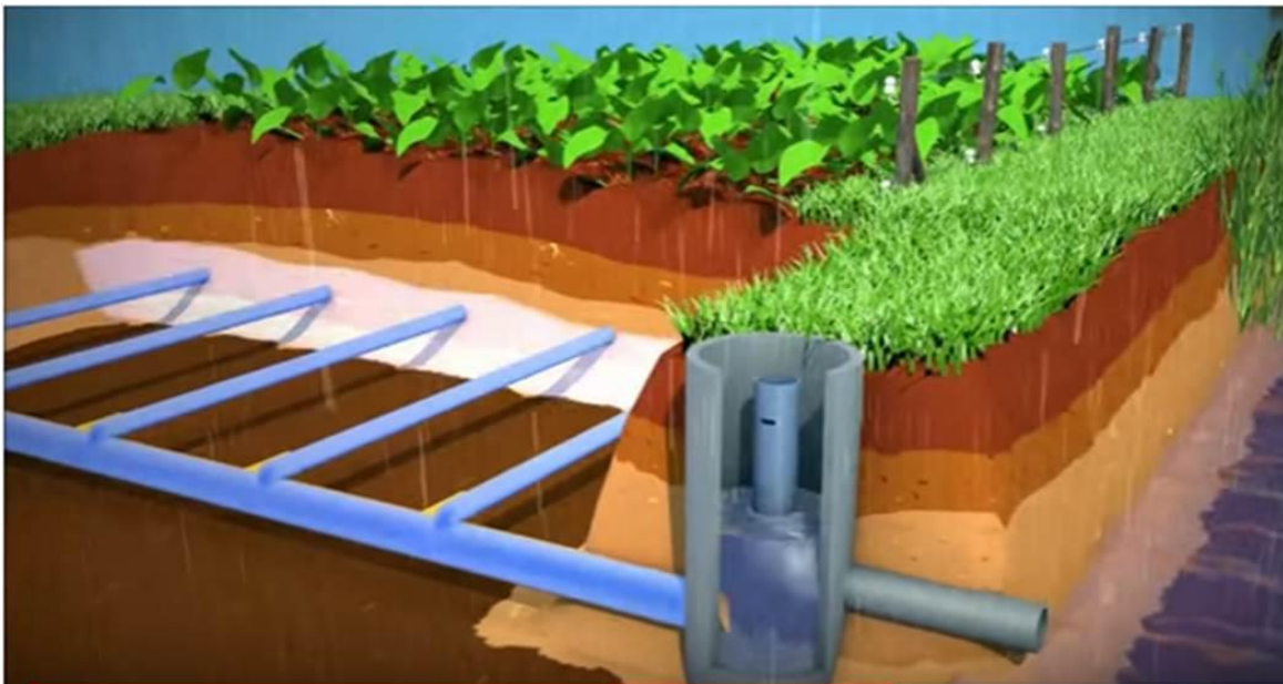
Figuur 1-1: Systeem voor samengestelde peilgestuurde drainage, met een regelput, verzamelleiding en drainagebuizen (Bron Agrobeheercentrum.be).
