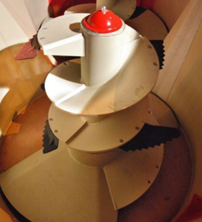
Vijzels met drie windingen in een Trioliet-voermengwagen. De spoel is recht met onder een verbreding. De platen zijn op elkaar gelegd voor het lussen.
