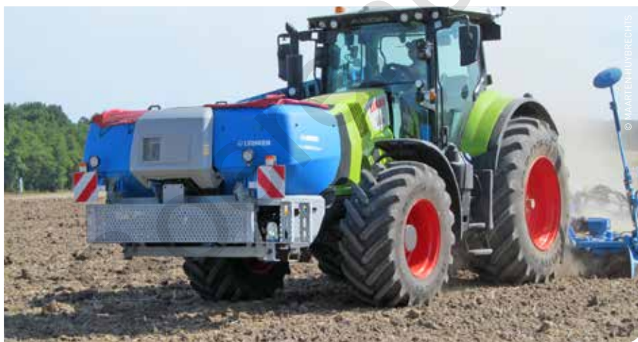
De nieuwe fronttank van Lemken zorgt voor een gunstige gewichtsverdeling van de gedragen zaaicombinaties. Er is veel belang gehecht aan gebruiksvriendelijke montage. De verbindingsslangen worden met snelkoppelingen uitgerust.
