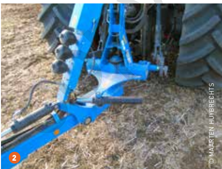
1 Om de achteras van de tractor te ontlasten, krijgt de Rubin 10 een volledig mechanisch aangestuurd steundwiel. 2 Voor de getrokken ploeg levert Lemken een Opti-Line en een Opti-Trac-systeem. De Opti-Linecilinder geeft een zijdelingse druk op de tractor. De Opti-Traccilinder ligt in de richting van de dissel en trekt via de ploegbok de tractor lichtjes achterover. Op de wendakker wordt het systeem automatisch ontlast. 3 De tandeneg achter de eerste schijvenrij wordt zeer eenvoudig in hoogte versteld door een nieuw tand-huegelsysteem.
