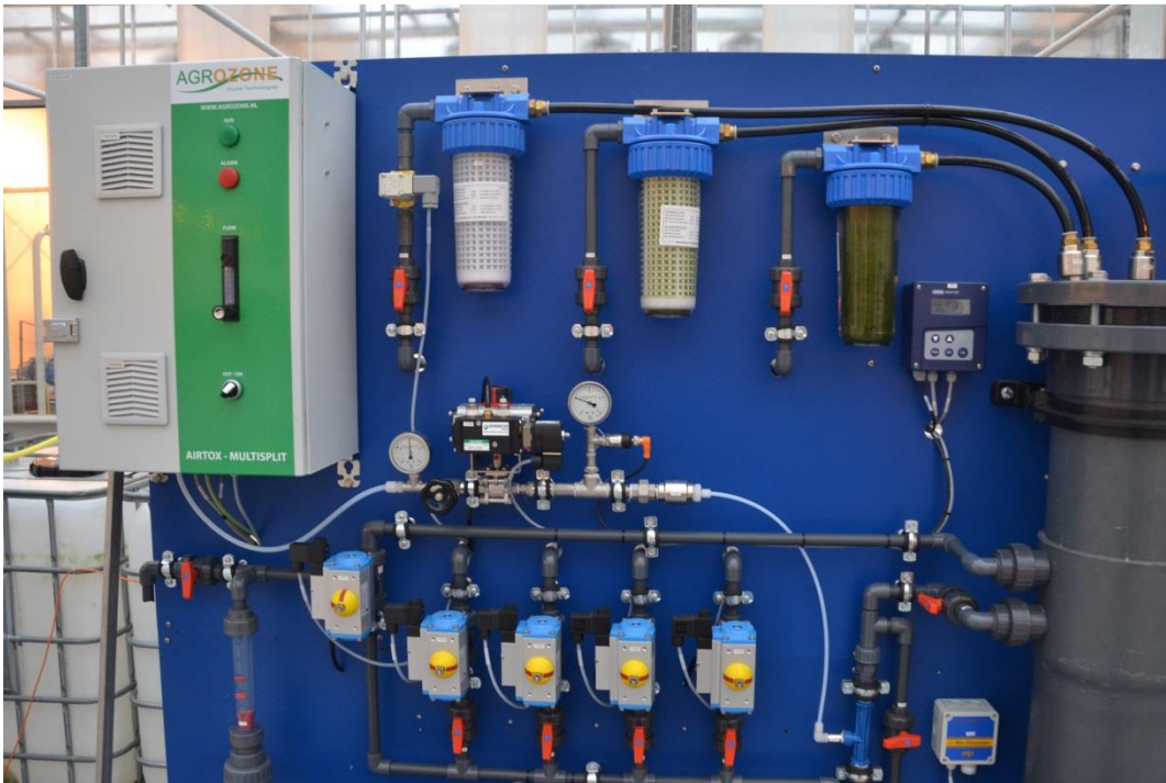
Figuur 4. De gebruikte (custom-build) ontsmettingsinstallatie op basis van ozon (Agrozone)
