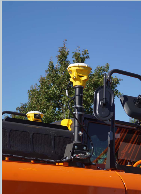
Trimble levert het GPS-systeem nu af-fabriek. Het is nog te herkennen aan de ontvangers. Hitachi benadrukt dat er ook GPS-voorbereide oplossingen komen voor andere merken GPS-systemen.
