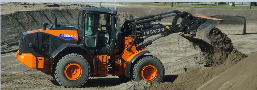
Bij de nieuwe bakfunctie blijft de bakhoek onafhankelijk van de giek en lepelstand hetzelfde. De bak volgt daarbij automatisch de ingestelde 3D-lijn.
