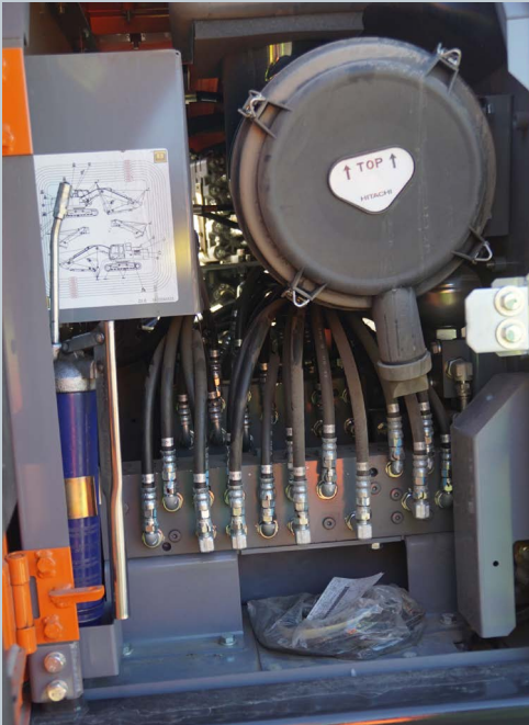
Hitachi ontwikkelde voor de nieuwe semi-automatische graaffuncties een nieuw ventielenblok, dat het juiste aantal liters geeft, precies afgestemd op de verschillende functies.
