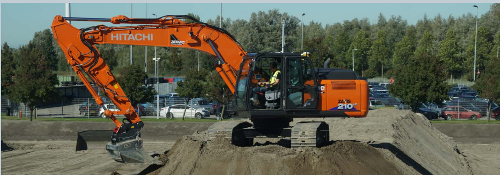
Bij de nieuwe bakfunctie blijft de bakhoek onafhankelijk van de giek en lepelstand hetzelfde. De bak volgt daarbij automatisch de ingestelde 3D-lijn.
