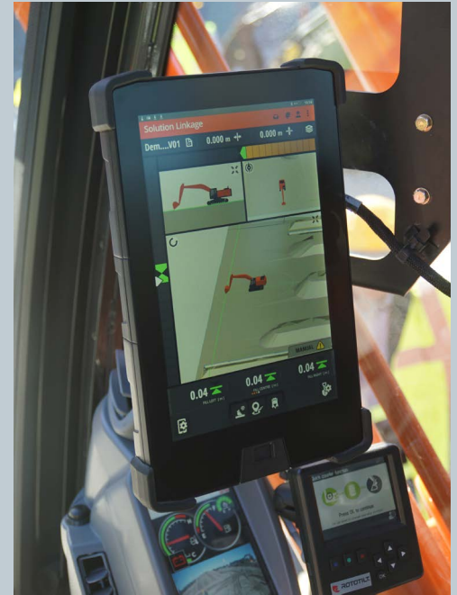
Hitachi ontwikkelde samen met Trimble dit tien inch metende bedieningsscherm. Werkt als een smartphone. Je kunt beelden oproepen, inzoomen en beelden maken van het werk en die verzenden.
