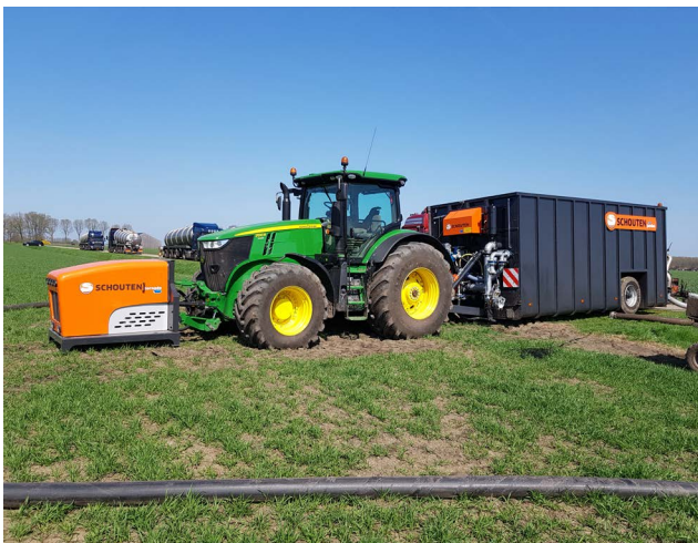
Schouten levert ook een pompwagen-variant met tussenopslag. Dit is met name in Duitsland een veel gevraagde variant, omdat de aanvoer van mest daar nogal eens verschilt.
