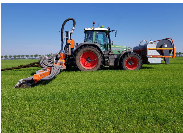
Bij Schouten is het de zodenbemester of de sleepvoet-bemester. Een alternatief is niet ontwikkeld. Wel is er nu een grotere Cobra FTH190-haspel met 1200 liter grote buffertank en 1000 meter slang
