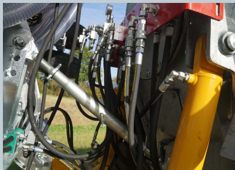
De bodemdruk wordt centraal via de hef hydraulisch ingesteld. Daar maak je de grote klap.
