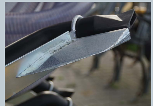
De sleepvoetbemester van Slootsmid heeft dezelfde voeten en ook een laag trekpunt, maar geen veren en geen snijschijven.
