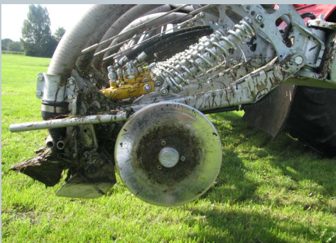
Slootsmid werkt met een laag trekpunt en veren voor een zo goed mogelijke bodemaanpassing.
