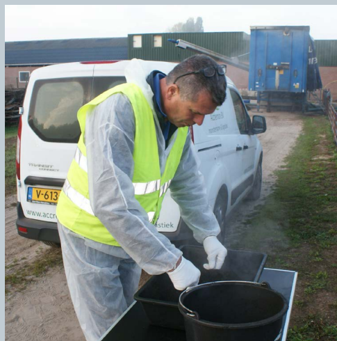
Het monster wordt in een bak gestort. Daarna begint het mengen en verdelen in vier kwarten, het kwartieren. Dit proces wordt twee keer herhaald.
