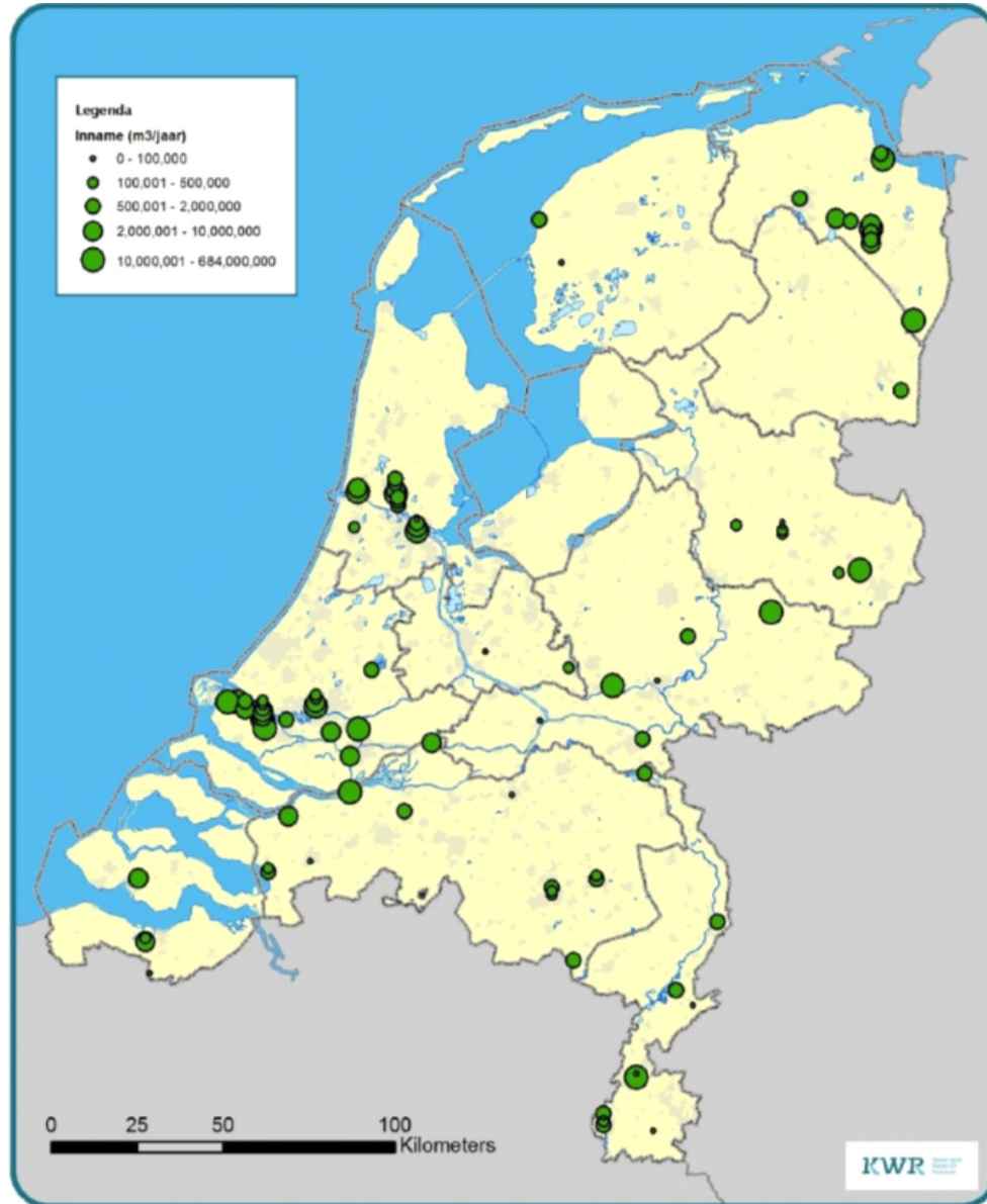
FIGUUR 4-1 INDUSTRIËLE INNAMEPUNTEN OPPERVLAKTEWATER VOOR GEBRUIK PROCESWATER (HUITING, 2014).
