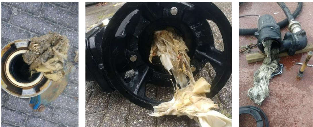
Afbeelding 2. Verstoppingen van pompen door doekjes/vochtig toilet papier
