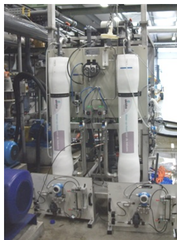
Afbeelding 3. AiRO-opstelling met twee parallelle 8 inch SWM RO-elementen bij Evides Industrierwater
