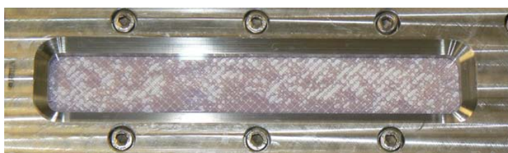
Afbeelding 4. Fijn verdeelde luchtbellens tijdens spoelen met lucht en water over de lengte en breedte van het membraan-kanaal
