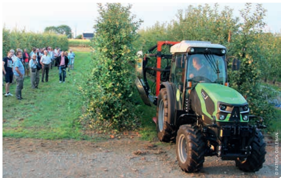
Demonstratie bladblazen op pcfruit. De machine beschikt over twee kappen met elk twee openingen. De onderste kan uitklappen om beter op het gestel te kunnen werken. Bemerkt links het vliegende blad.
