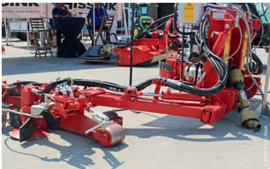
De Krümmer Ladurner heeft 2 rotoren die worden aangedreven door de aftakas.
