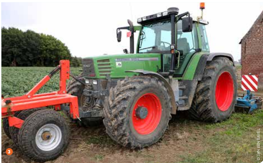
1 Alexander Dejonghe gebruikt deze optische kleursorteerder van Deman, die 90% van de 'slechte' spruiten verwijdert. 2 De familie Neyens investeerde voor de bloemkoolteelt in bufferbekkens en in 2018 in een nieuwe beregeningshaspel met Komet 160-sproeier. 3 Koen Keirsebilck investeerde in lagedrukbanden ten behoeve van een goede bodemstructuur.
