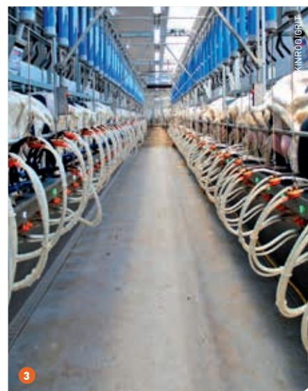
1 Zicht op een van de vier U-vormige potten. In elke pot is plaats voor 800 geiten. 2 3 De 2 x 50 rapid exit -melkinstallatie kan ongeveer 700 geiten per uur melken.
