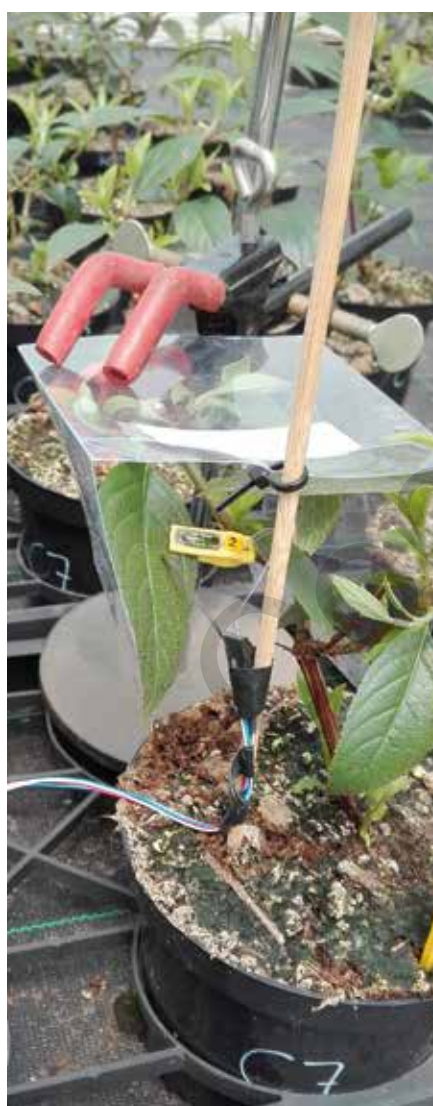
De Leaf clip sensor op Hydrangea meet continu de bladdikte
