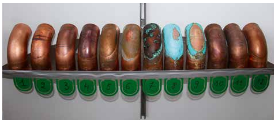
Resultaat van corrosietesten PCS op koperen buizen (blauwe corrosie door javel-producten)
