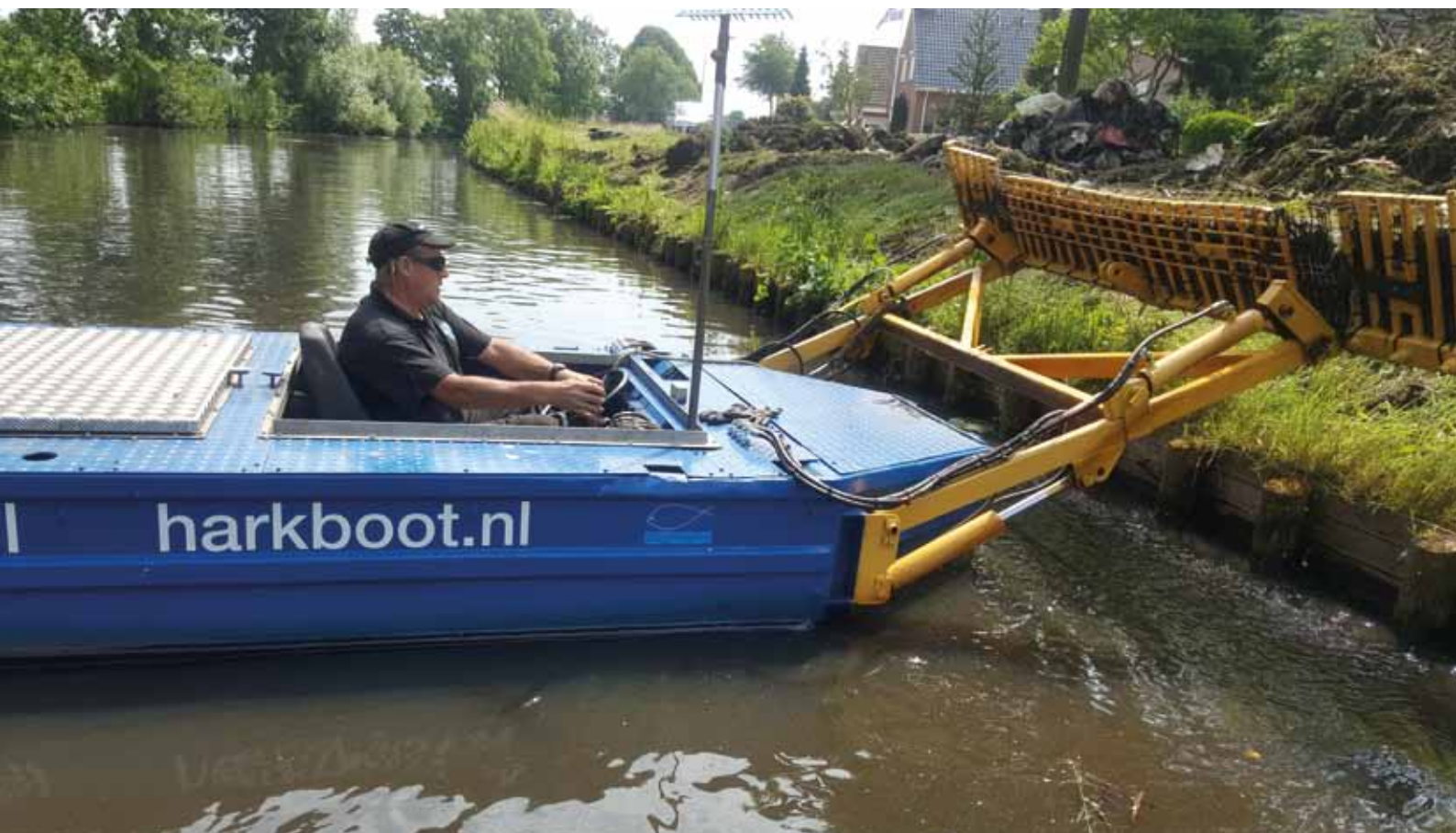
Enmaal losgetrokken met de hark, hoeven de waterplanten alleen nog maar te worden opgeschept.
