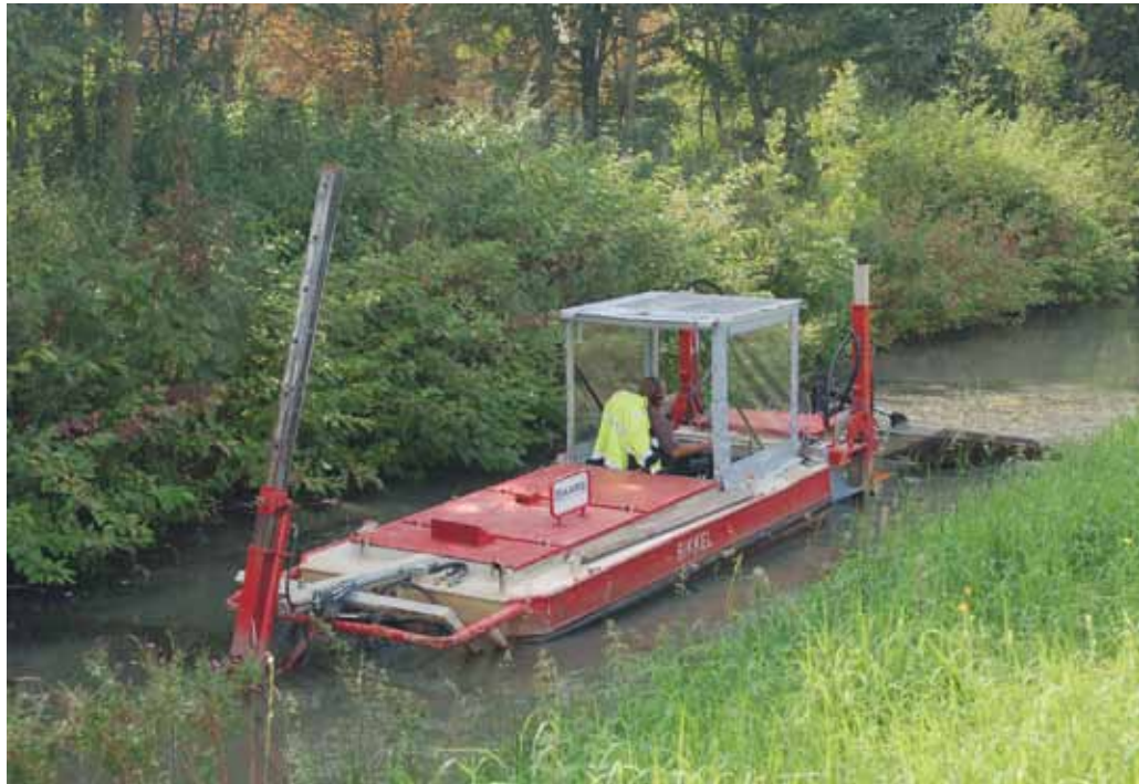
Nadat de hydroventuriboot zich aan de achterkant heeft vastgestempeld, beweegt de arm met daarin de spuitbuis zich heel langzaam van links naar rechts onder het wateroppervlak.
