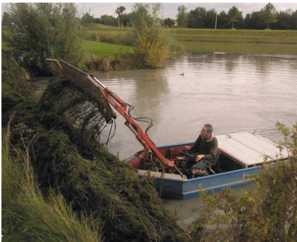
Aan het einde van de dag wordt het drijfvuil verzameld met de boot met rietbak. Dat moet dezelfde dag gebeuren, zodat de plantenresten niet kunnen wegdrijven naar andere wateren.
