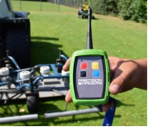
De machinist draagt een kleine afstandsbediening met een koord om zijn nek, waarmee hij de machine op afstand kan aan- en uitzetten.
