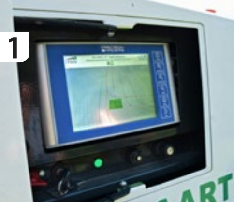
Op een touchscreen aan de zijkant van de machine stel je in hoe de Greenbot het sportveld moet maaien.
