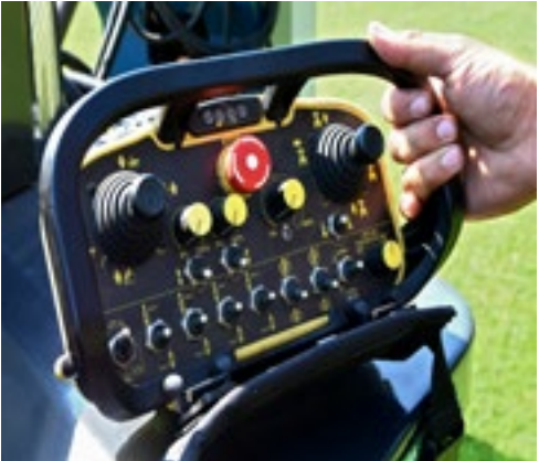
Met de grote afstandsbediening kun je de Greenbot naar een volgend sportveld brengen of op de vrachtwagen rijden.
