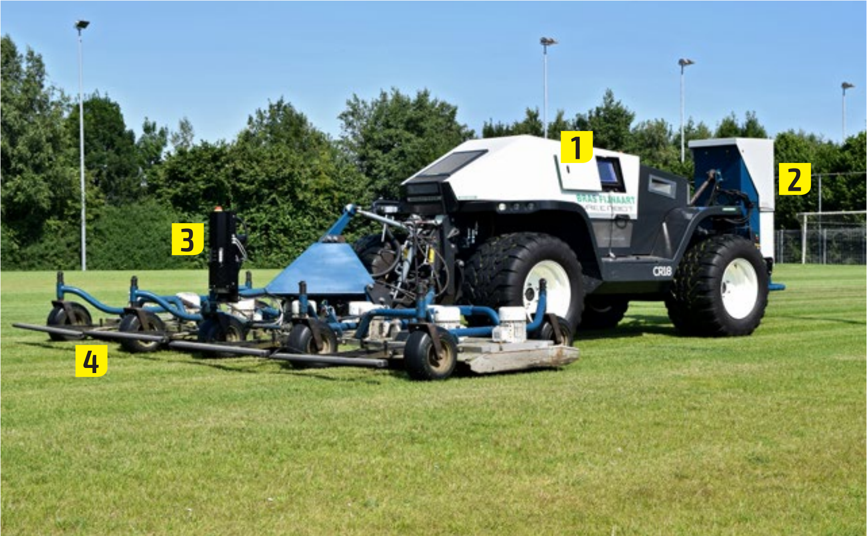
De Green Clipper is een elektrische maaier. De trekker wekt de stroom op via een generator die wordt aangedreven door de aftakas van de Greenbot.
