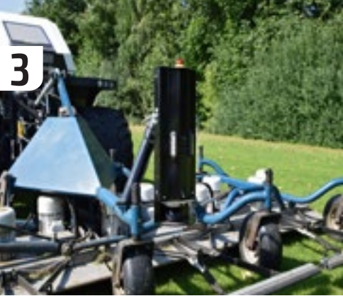
Een radar voorop de maaier scant de omgeving. Zodra de radar een obstakel waarneemt, gaat hij langzamer rijden en stopt hij uiteindelijk.
