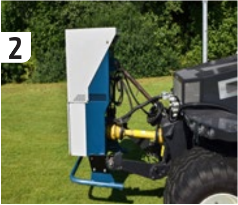
De Green Clipper is een elektrische maaier. De trekker wekt de stroom op via een generator die wordt aangedreven door de aftakas van de Greenbot.
