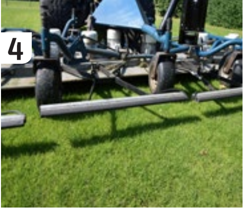
Mocht de radar onverhoopt niet werken, dan houdt de machine er onmiddellijk mee op zodra het obstakel tegen de aanrijdbeveiliging aankomt.
