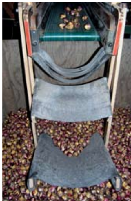
Valbeschadiging is te beperken door het aanbreken van een valbreker
