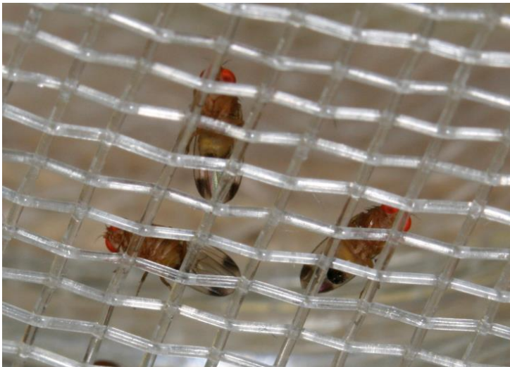
Insectengaas met een maasopening van 0.92x1.25 mm. Een enkel mannetje kwam er doorheen, de vrouwtjes niet.
