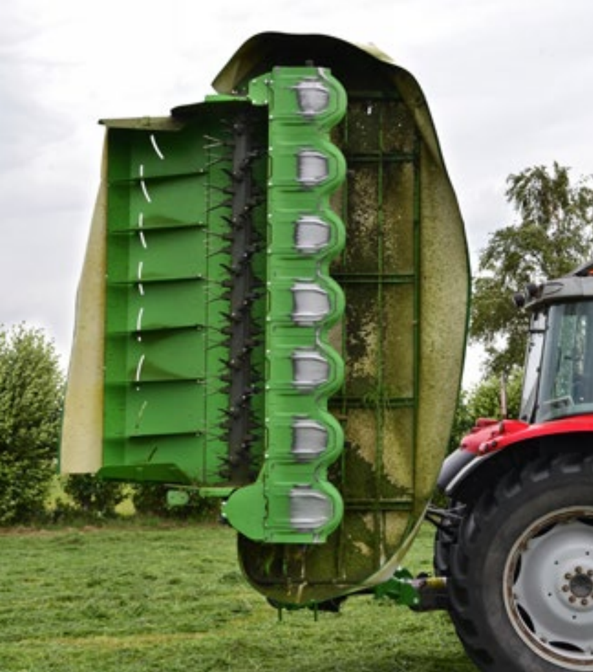
De robuuste maaibalk is standaard voorzien van slijtageglijssloffen. De kneuzer met vaste stalen tanden werkt goed. De breedspreidinrichting werkt minder goed.
