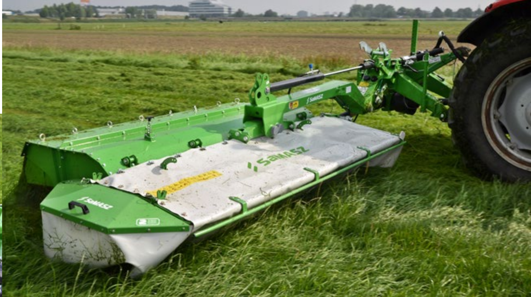
De bodemvolging is mede door de hydropneumatische bodemontlasting goed. Met een eenrichtingsmoorventiel bovenop de cilinder is de daalsnelheid instelbaar. De beschermdoeken zijn degelijk en in drie standen opklapbaar om bijvoorbeeld messen te kunnen wisselen.
