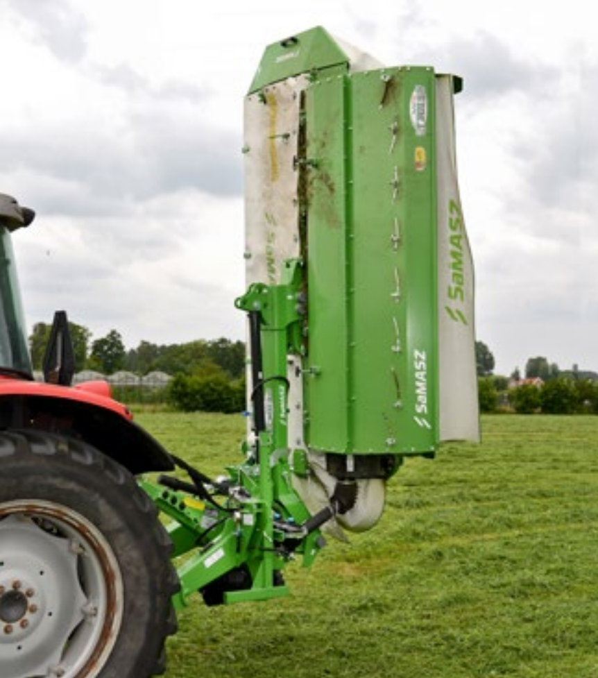
Transportstand. De maaier klapt zowel omhoog als naar achteren. De maaier kan in de schuur zowel in de lengte als in de breedte worden neergelegd.
