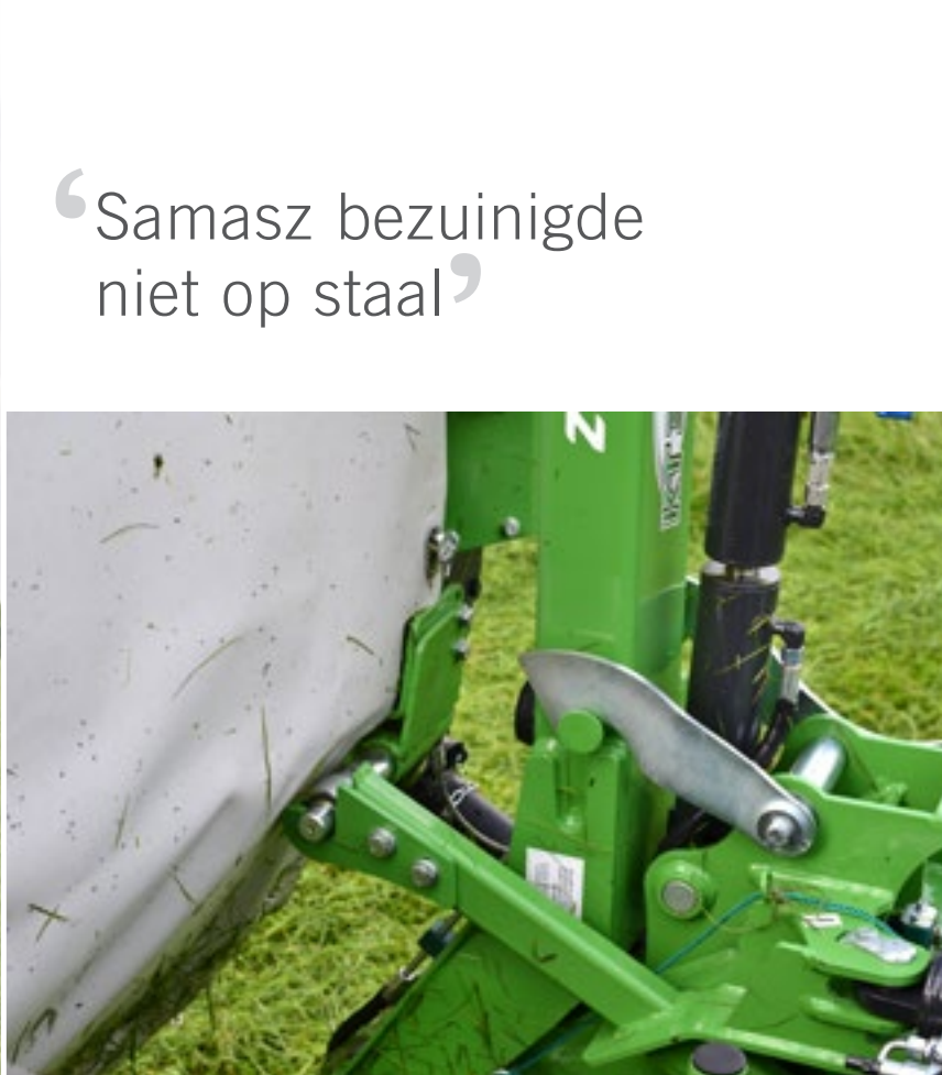
Doordacht: de maaier wordt tijdens transport niet alleen beveiligd tegen zakken, maar de groene haak links voorkomt dat de maaibalk kan pendelen.
