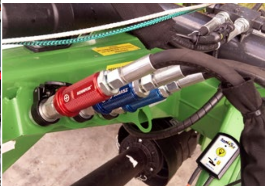
De hydrauliekslangen hebben een degelijke bescherming. De Kennfix-markering is chique en zorgt voor makkelijk aankoppelen.
