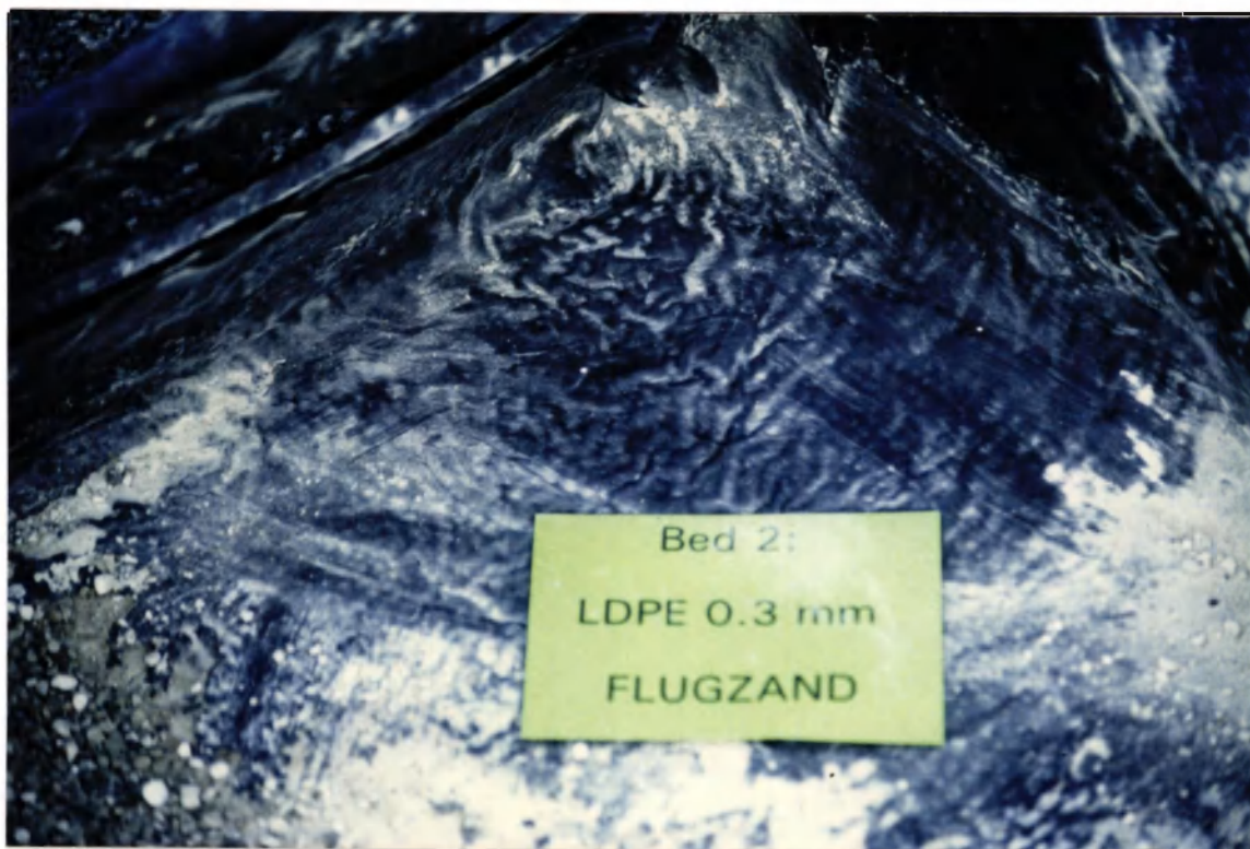
Figuur 8: Opegegraven bedhoek van bed 2 met flugzand als substraat, folie LDPE 0.3 mm. De folie heeft een reliëf-achtig oppervlak. LLDPE 0.35 mm heeft dit ook.
