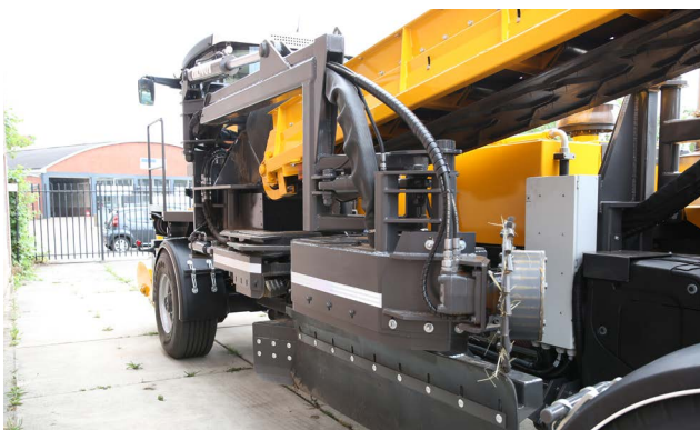
De machine in transportstand. De freeskoppen vouwen onder de afvoerband. De transportbreedte blijft zo onder de 2,55 meter.
