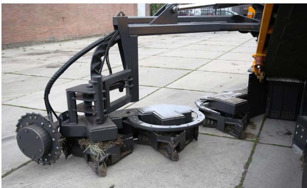
De frees werkt met drie freeskoppen, een voorsnijschijf en een schoepenwiel dat het materiaal op de afvoerband brengt.
