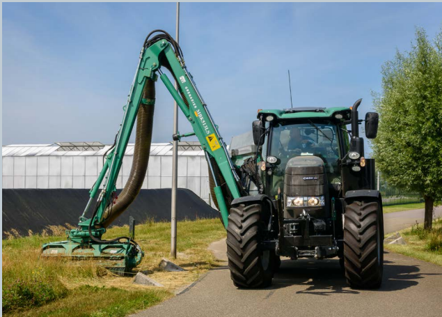
Voor de gemeente Westland doet Berkhout nogal wat bermonderhoud. Deze maaizuigcombinatie in bedrijfskleuren wordt ingezet voor het grotere werk.
